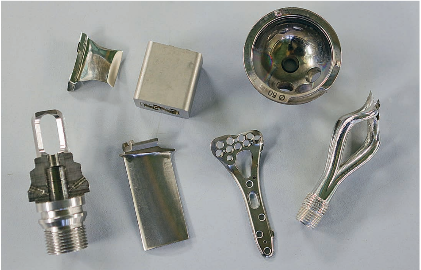
Ультразвуковое деформационное упрочнение позволяет увеличить усталостную прочность лопатки турбины авиационного двигателя более чем в 10 раз
